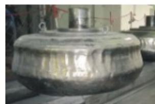
某电厂高铬辊套运行 5300h后工作表面磨损出现 深犁沟，最大磨深65mm
