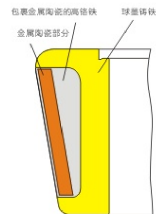
HP、RP磨煤机辊套内部结构
