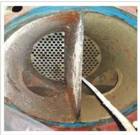
没有使用物理除垢装置的换热器
